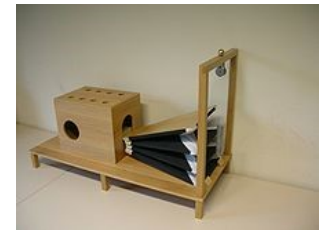
Figure 1: Kempelen beszélő gépének rekonstrukciója (forrás: wikipedia)
